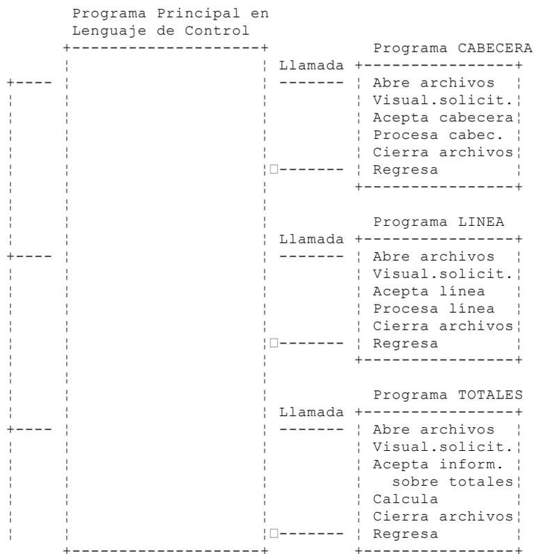
Figura 14. Ejemplo de diseño de aplicaciones para una función de entrada de pedidos
